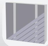
Pose diagonale simple lambourrage
